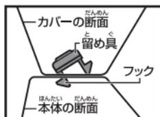
図のように留め具を傾けながら片方のフックに引っ掛けのように穴に差し込みます。
