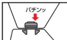
「パチンッ」と音になるまで留め具を上から押し込んでください。4カ所の穴全てを固定して完成です。
