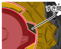
ロックできていない状態
