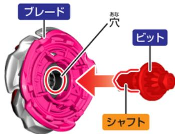
② **ブレード**の外周部分を持ちながら、差し込んだ**ビット**を矢印の方向にひねります。
